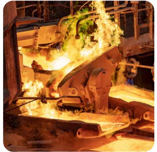
> Am Anodengießrad in Hamburg wurde die Testreihe durchgeführt.
